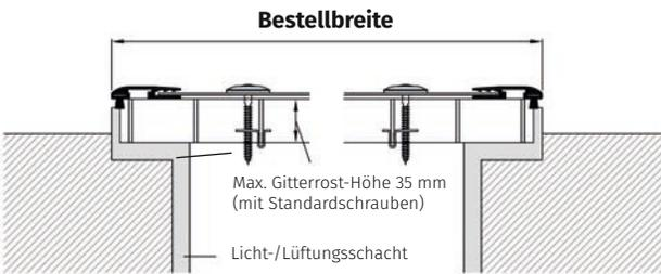
**Vertikalschnitt V2:** LSA-Rahmen bündig mit Gitterrost (LSA lässt sich unter Umständen einfacher zusammen mit dem Gitterrost entnehmen)
